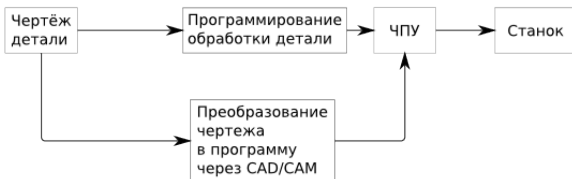
Рис. 1.1.1: Обработка детали на станке
