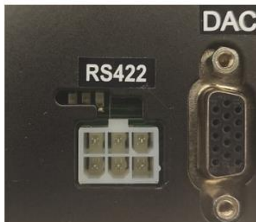
Рисунок 9 – Распиновка разъема со стороны ЧПУ TITANIUM
